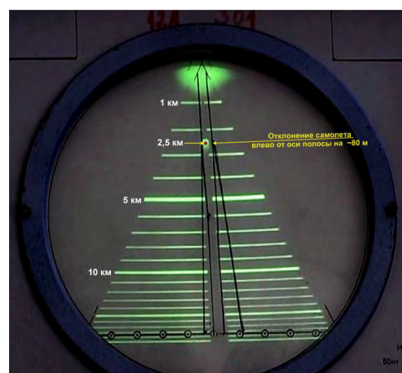
Фото 31. Изображение позиции самолёта относительно глиссады и оси ВПП на индикаторах WISP-75
