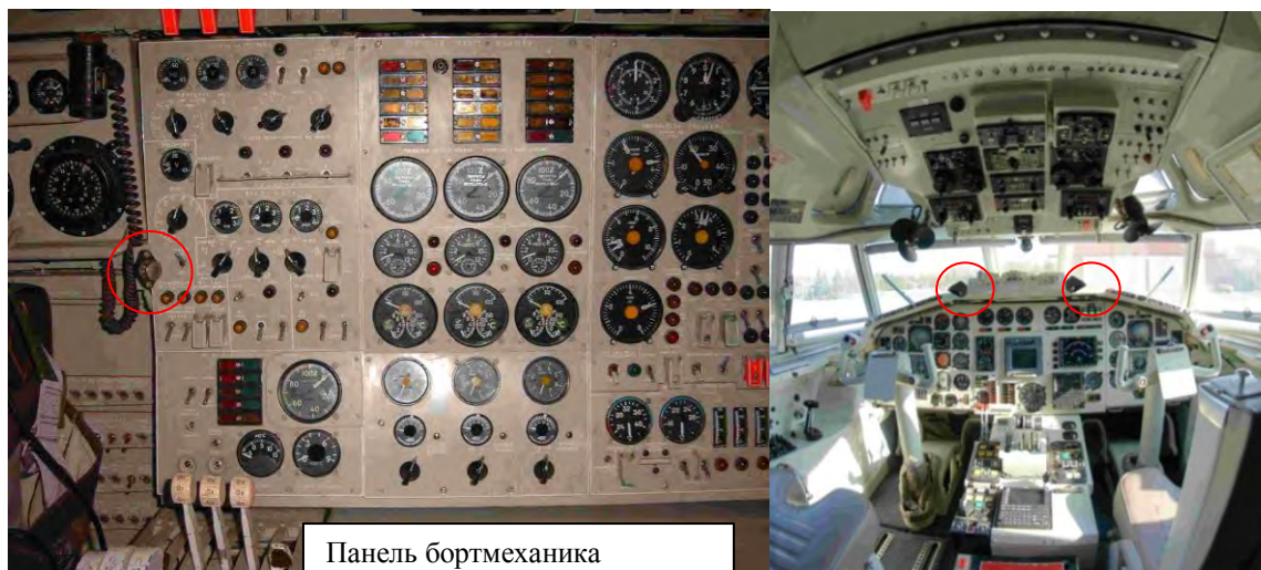
Фот. 12. Размещение микрофонов в кабине самолета ТУ-154М
