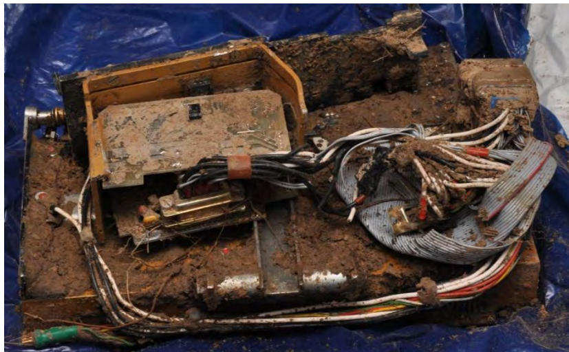
Фот. 10. Снимок самописца ATM-QAR на месте происшествия
